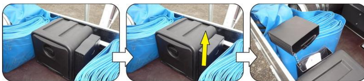
Obr. 16b Schránky pro uložení dokumentů; směr sejmutí krytu schránky; otevřená schránka
