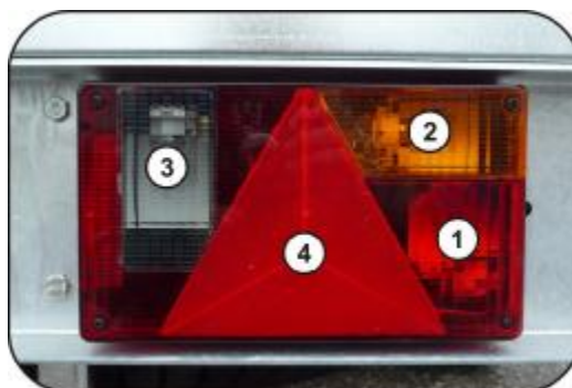
Obr. 20 Zadní sdružená svítidla – popis
