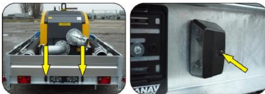
Obr. 22 Osvětlení registrační značky; šroub držící plastový kryt světlíky
