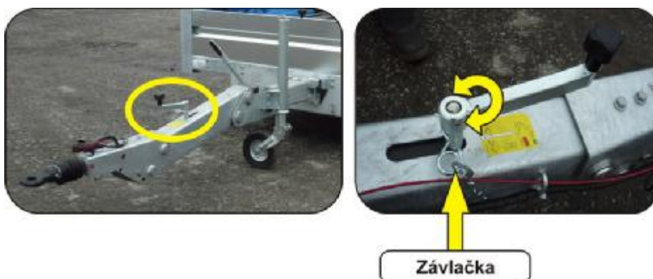
Obr. 10 Kliky k nastavení výšky tažné oje
