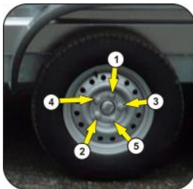
Obr. 18 Pořadí dotáhnutí matic kola
