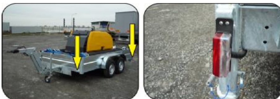
Obr. 21 Umístění obrysových svítidel; zadní obrysová svítidla
