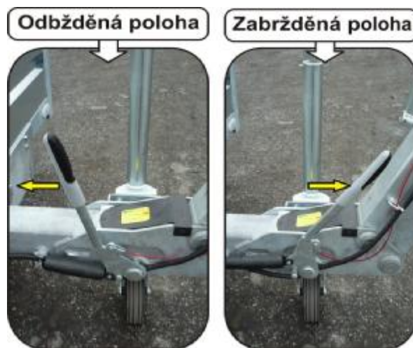
Obr. 7 Ruční parkovací brzda – poloha při odbržděném přívěsu; poloha při zabržděném přívěsu
