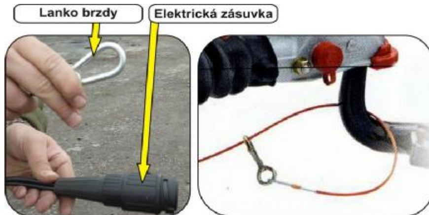
Obr. 8 Karabina lanka brzdy; příklad uchycení lanka brzdy na tažném vozidle
