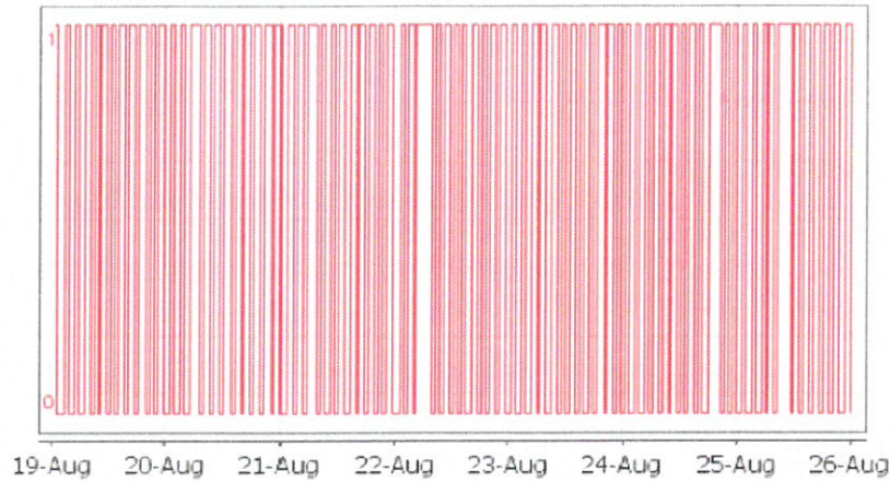
Obrázek 1: Týdenní provoz tepelného čerpadla Robur. 0 a 1 znamená vyp/zap, procentuální hodnota je doba strávená v jednotlivém režimu, číslo „80“ je počet zapnutí a vypnutí v daném období.
