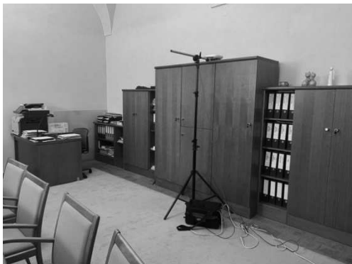
Obrázek 3-2 Umístění AP na skříň
