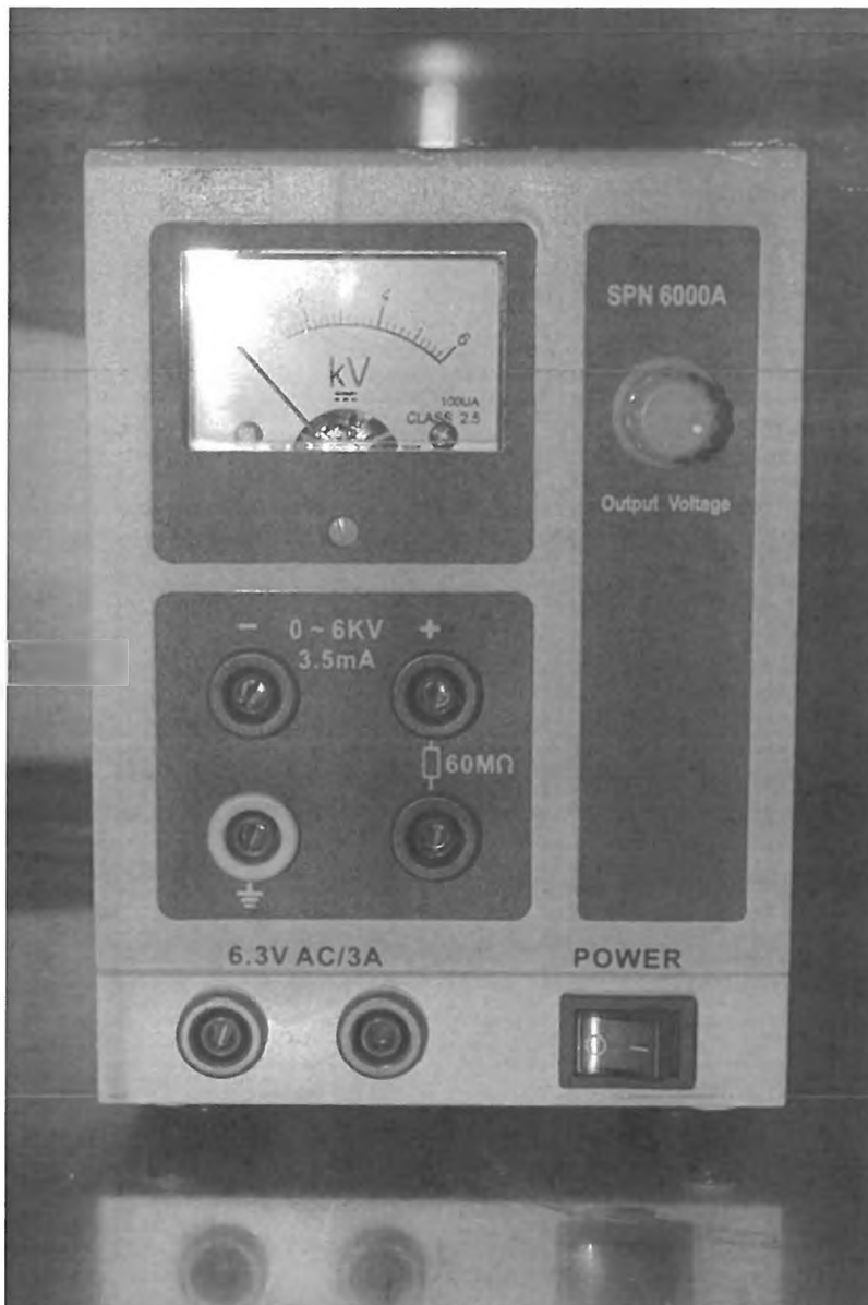
Externí zdroj statického napětí pro zvýšení depozice
