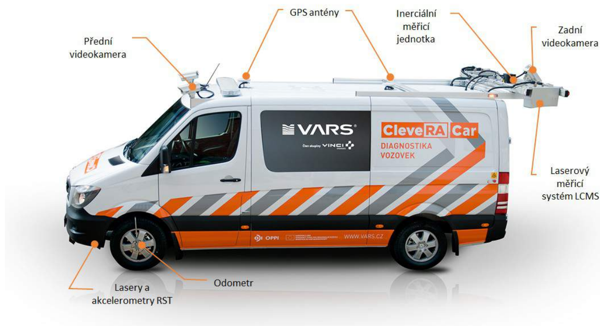
Obrázek č. 114 Multifunkční vozidlo pro měření povrchu vozovek a jejího nejbližšího okolí
