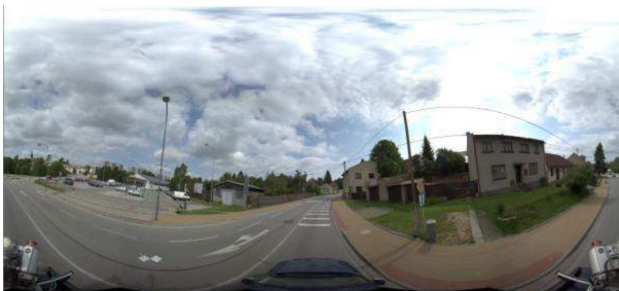
Obrázek 50- složený sférický snímek z kamery LadyBug5 - v levé části na povrchu komunikace vlíčovací bod pro urovnání mračna bodů
