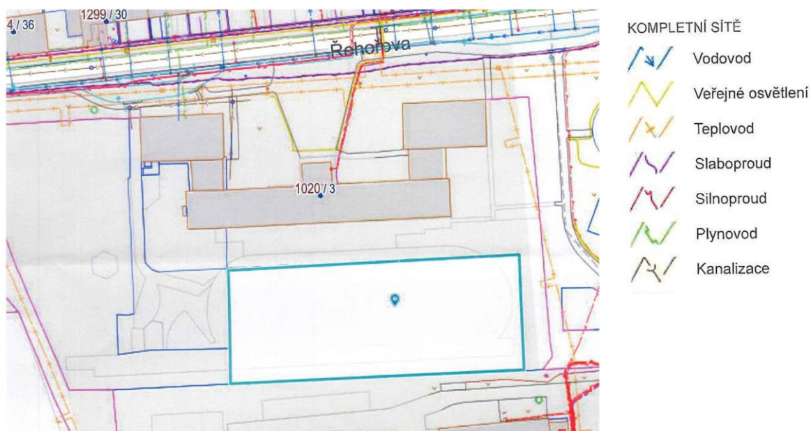
Obr. 2: technické sítě, zdroj: MČ Brno-Černovice
