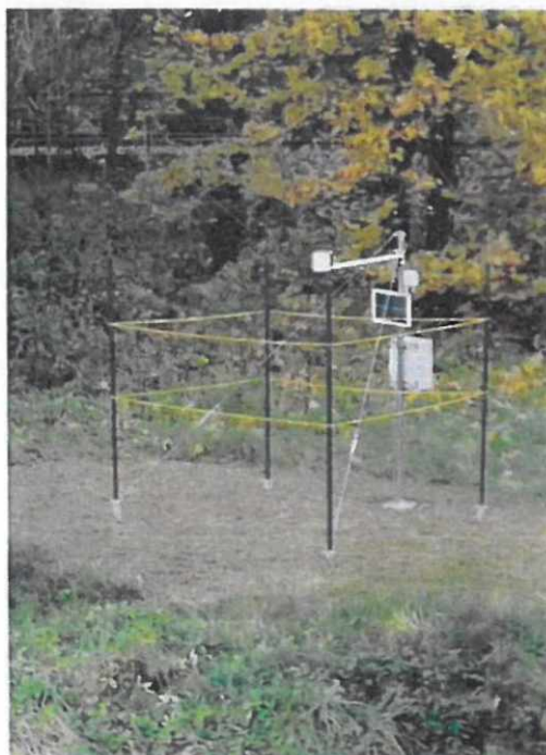
Obrázek 2. Doporučená podoba ohrazení měřícího prostoru sněhoměru stanice AMS-E-R.
