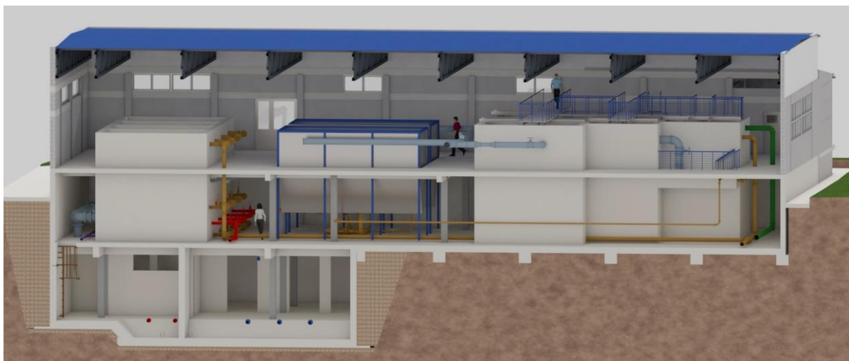
Obr. 35 Příloha z PD: čtyři gravitační rychlofiltry v rámci NTL
