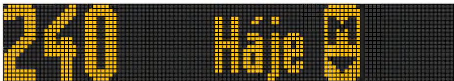
Obrázek 4: Nepřípustné zobrazení cílové zastávky na bočním tablu
