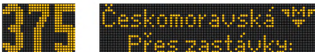
Obrázek 6: Správné použití rozděleného bočního tablu
