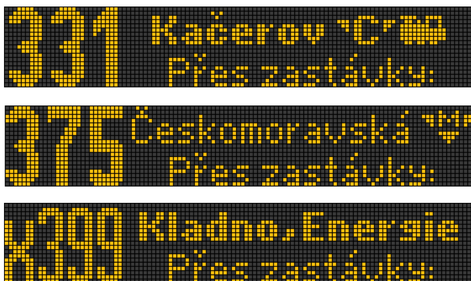
Obrázek 3: Vnější informační panel boční
