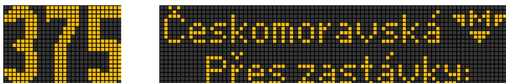
Obrázek 6: Správné použití rozděleného bočního tablu
