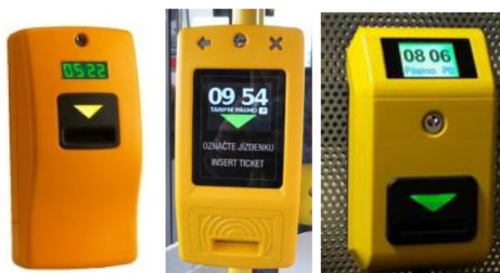
Obrázek 10: Příklady provedení označovače jízdenek NJ 24C, Camel-Combi (uprostřed) a ETM 4.0 (vpravo)
