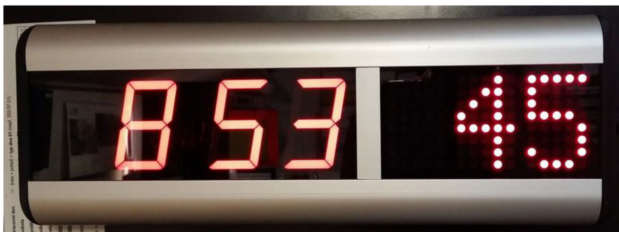
Obrázek 9: Zobrazovač času a pásma ZOCP-3P/ETH
