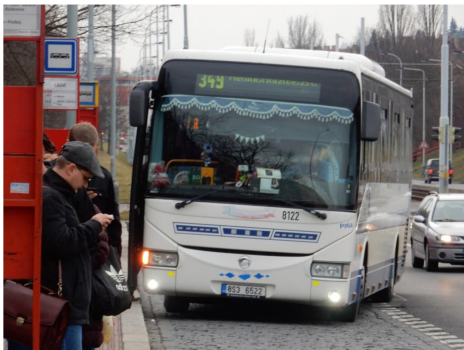
Obrázek 2: Nesprávné zobrazení informací na vnějším předním informačním panelu
