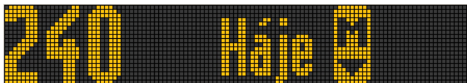
Obrázek 4: Nepřípustné zobrazení cílové zastávky na bočním tablu
