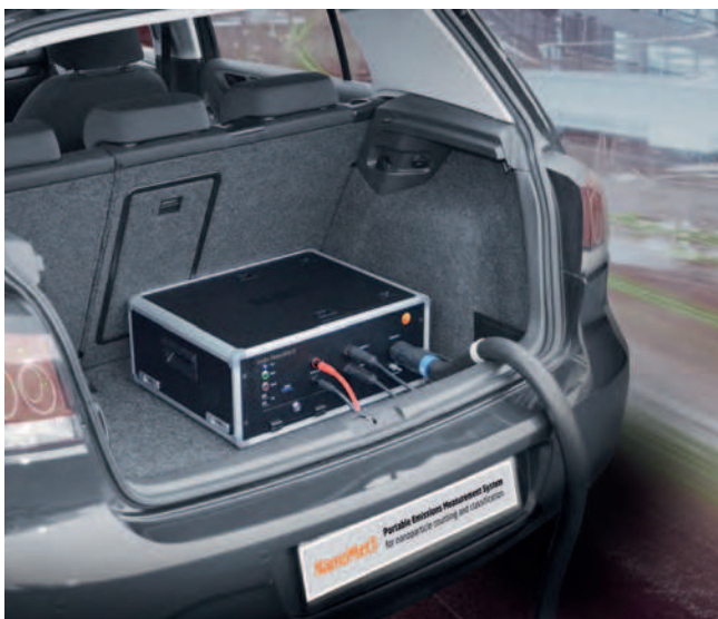
Využití testu NanoMet3 pro silniční zkoušku (RDE).
