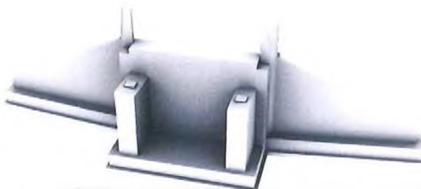
Tvarové řešení krajních opěr
