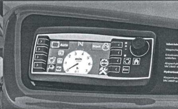
Barevný displej s otočným voličem otáček motoru a tlaku čerpadla
