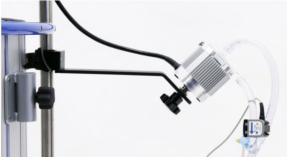
Obrázek 31: Zcela smontované uložení Motoru s Motorem
