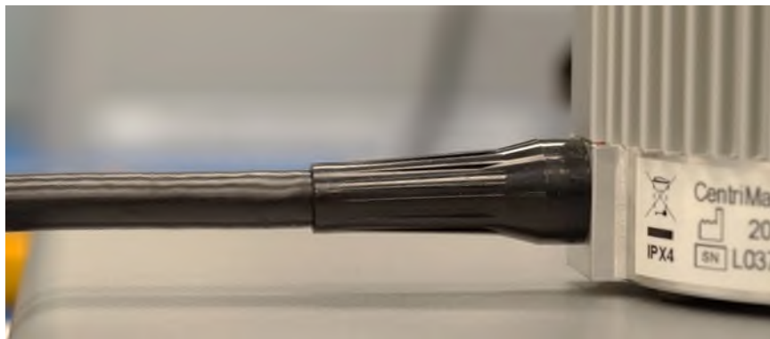
Obrázek 59: Výztuž kabelu u motoru
