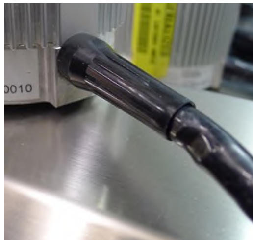
Obrázek 60: Poškozený kabel u výztuže kabelu u motoru
