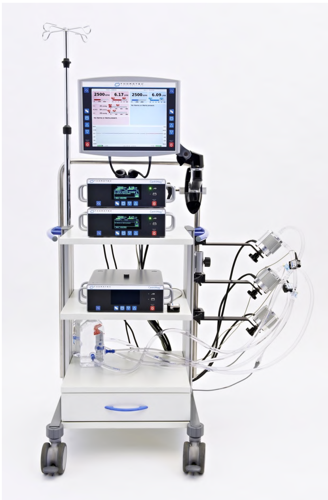
Obrázek 19: Pojízdný vozík, 2 hlavní a 1 záložní primární Konzole CentriMag 2. generace a Monitor Mag Dále jsou zobrazeny Snímače Průtoku, 3 Motory a dvě vodou naplněné tréninkové smyčky připojené k Pumpám CentriMag
