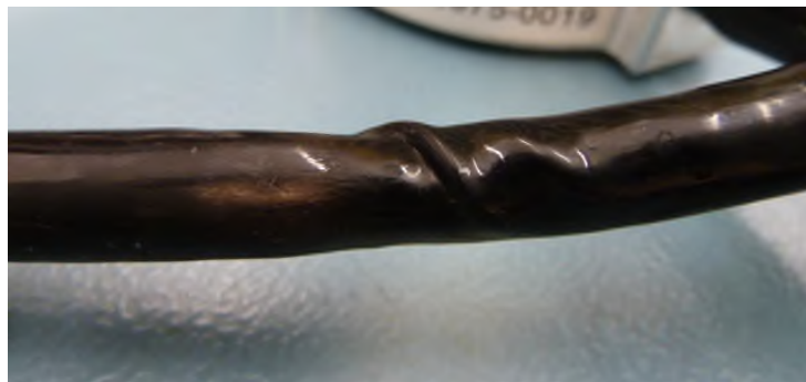
Obrázek 62: Poškozený kabel motoru
