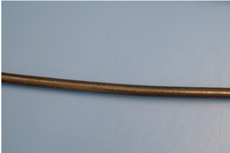
Obrázek 61: Nepoškozený kabel motoru
