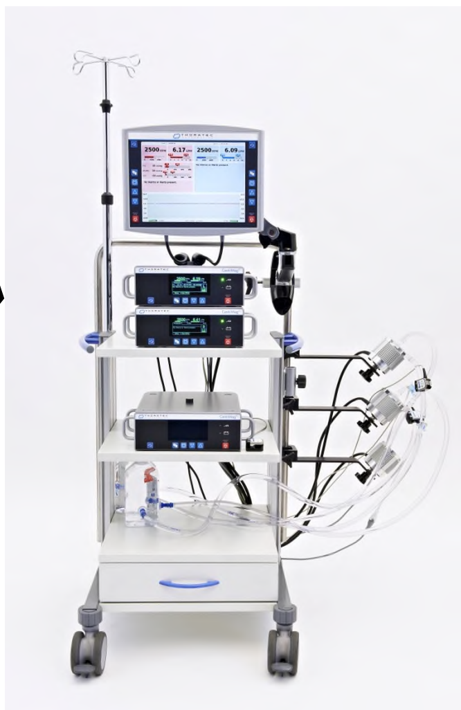
Obrázek 32: Konfigurace BiVAD – všechny napájecí kabely Konzolí musí být zapojeny přímo do zásuvky ve zdi.
