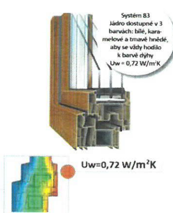
Trojité prosklení 48 mm Distanční rámeček SWISSPACER V, argon
