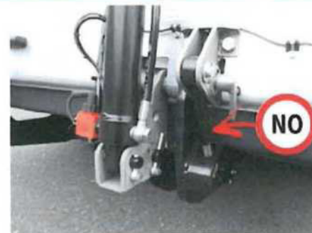
OAP434.Z - Platforma DH-LSP bez dorazů pro uzavření
