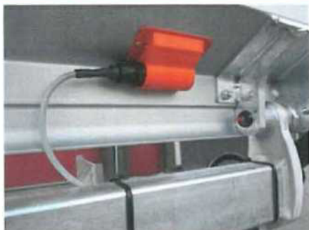
OAE502 - Rtuťový spínač na platformě
