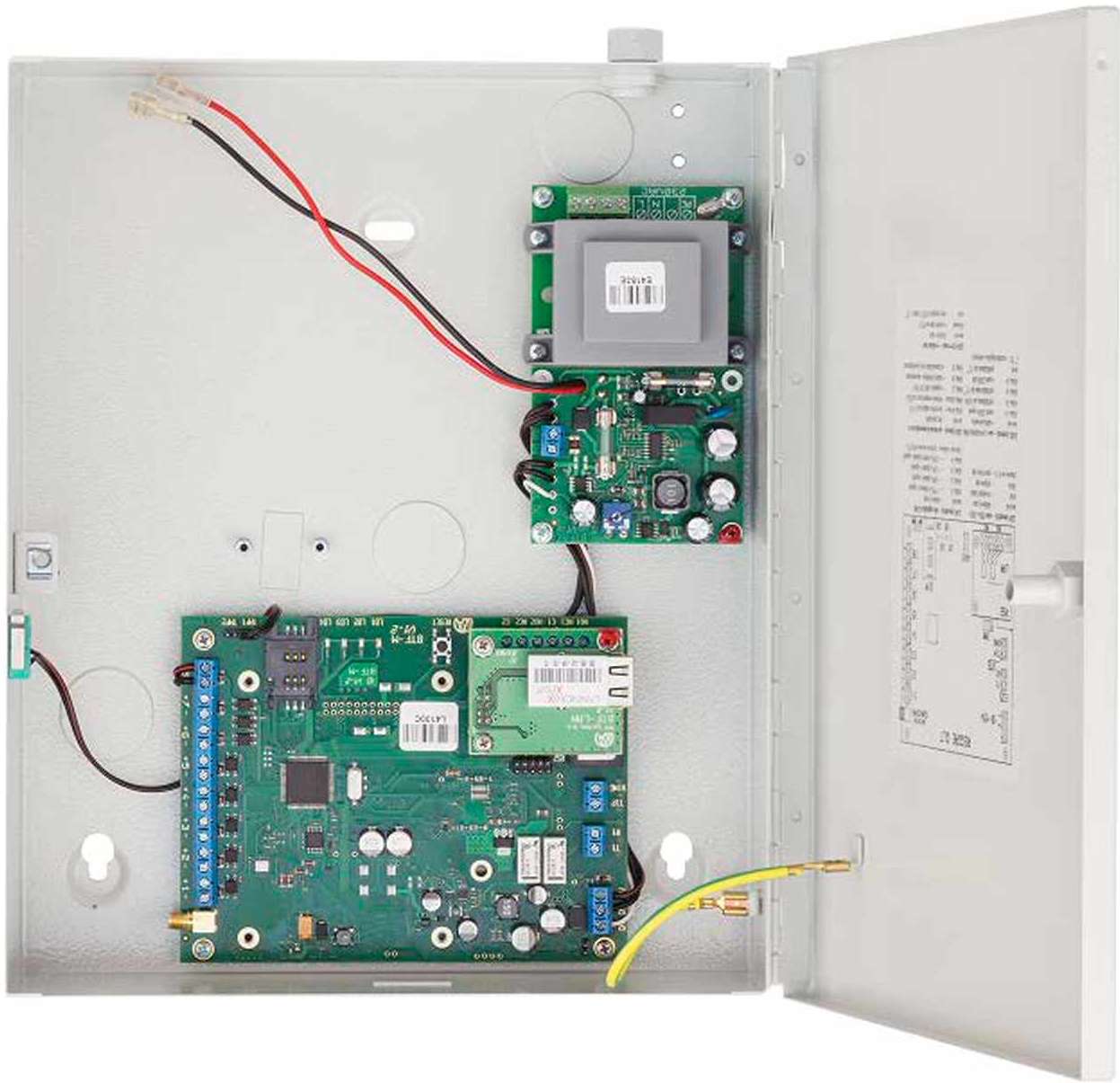
RaggaGLT - otevřená skříň se zdrojem
