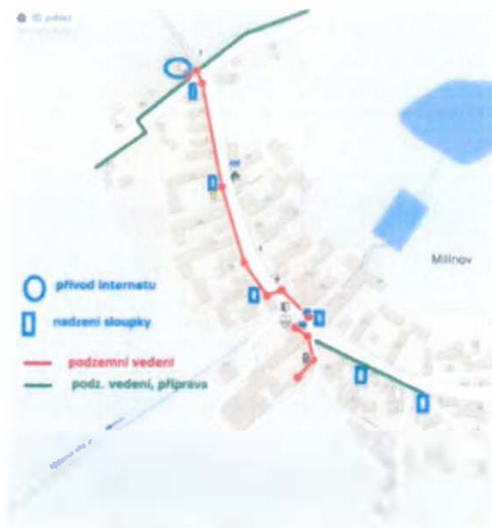
Schéma optické sítě Milínov
