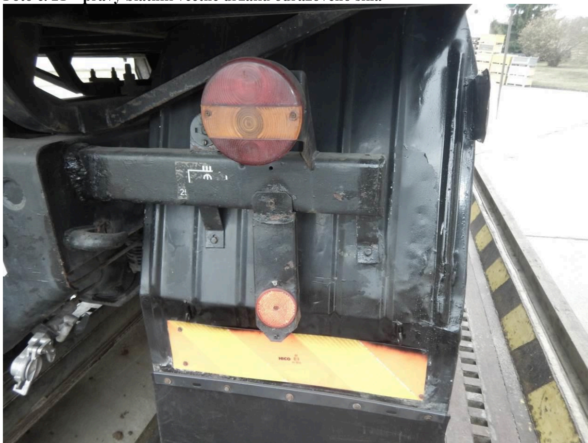
Foto č. 21 – pravý blatník včetně držáku odrazového skla
