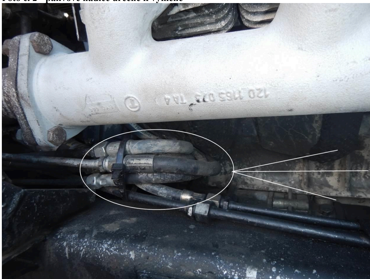
Foto č. 2 - palivové hadice určené k výměně
