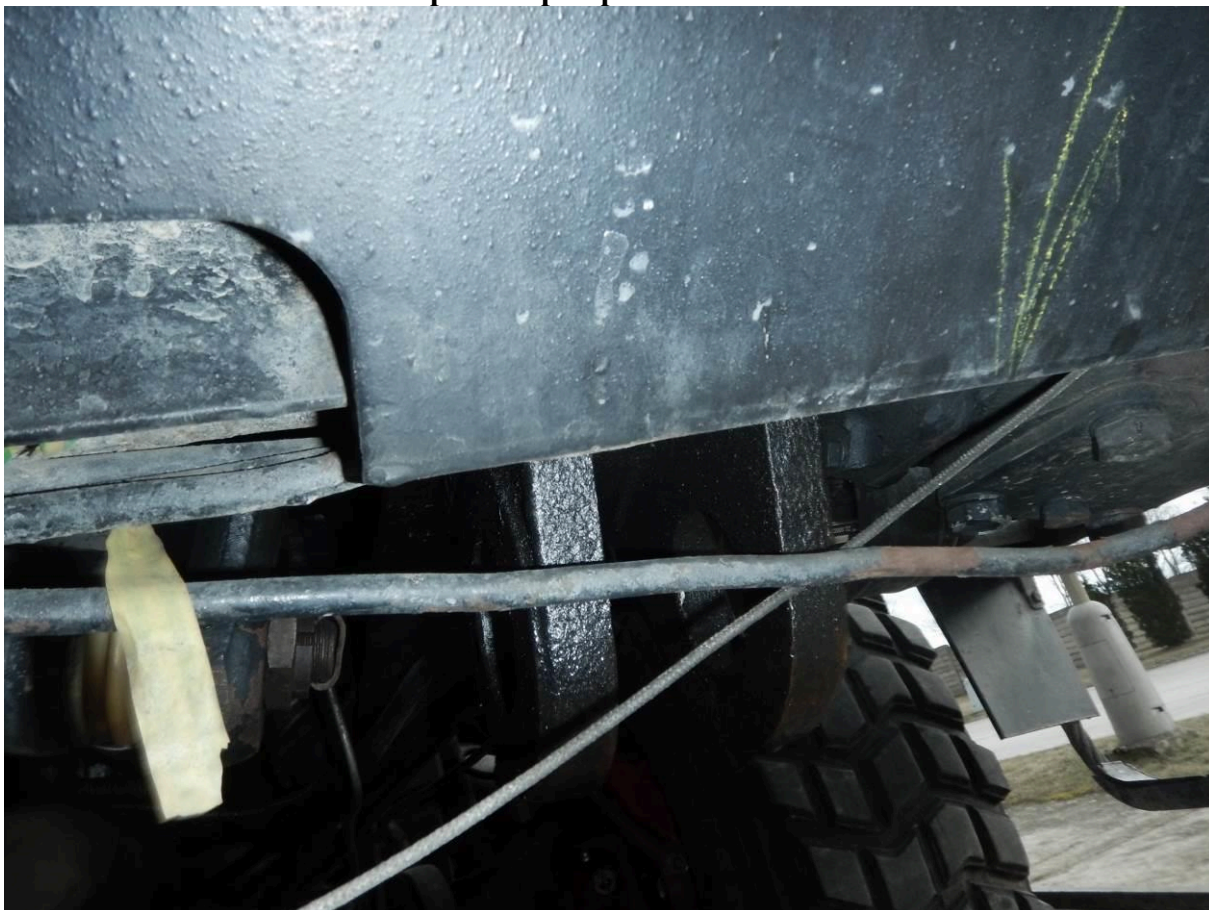
Foto č. 16 – svěšené vzduchové potrubí pod předním nárazníkem
