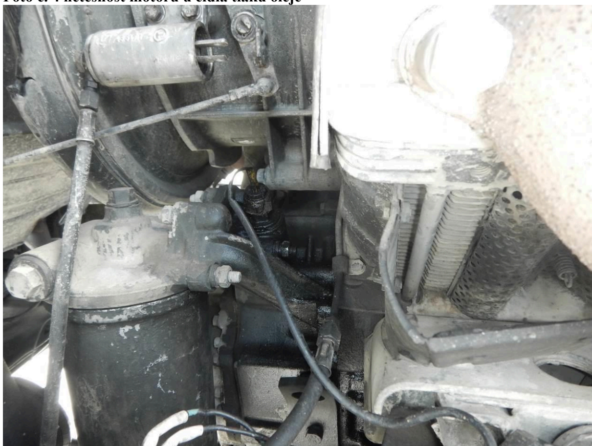
Foto č. 4 netěsnost motoru u čidla tlaku oleje
