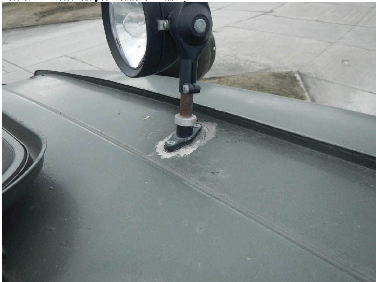
Foto č. 14 – netěsnost pot hledáčkem kabiny
