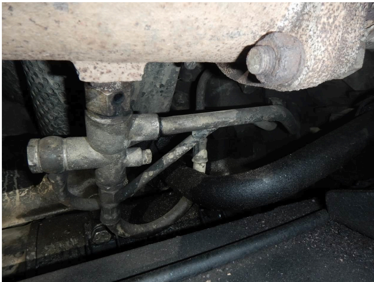
Foto č. 4 netěsnost motoru u čidla tlaku oleje
