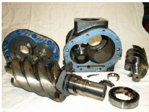
Ukázka neopravitelné šroubovice při provozu bez pravidelného servisu (30kW)
