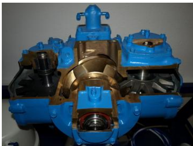
Řez šroubového bloku bezmazného kompresoru s vodním vstřikem (37 kW)
