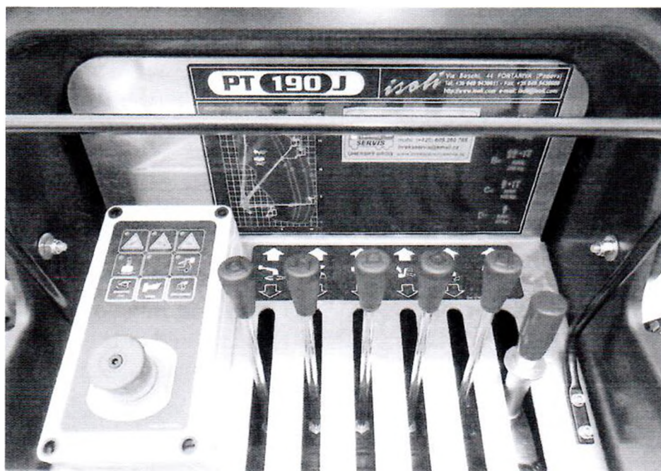
Obr. ovládání v pracovní klecí - proporcionální hydraulický ovladač umožňuje více pohybů plošiny najednou a zaručuje plynulost pohybů ramen.
