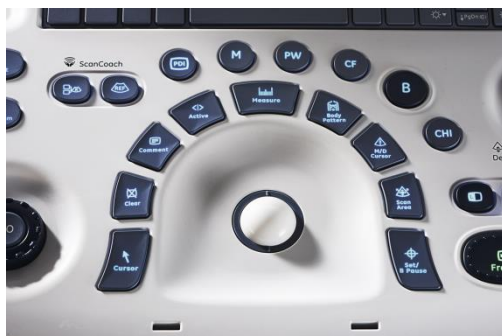
Obr. č. 3: Detail ovládacího trackballu LOGIQ V2
