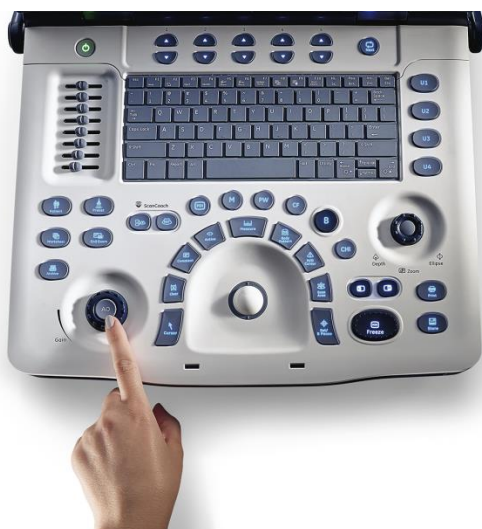
Obr. č. 4: Detail ovládacího panelu a funkce AUTO (automatické optimalizace)
