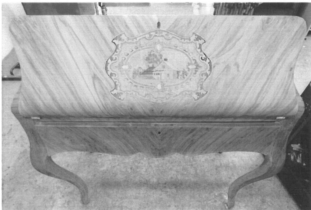
Na detailním snímku pohled napřeni část stolku po odstranění staré politury, příprava pro novou polituru.
