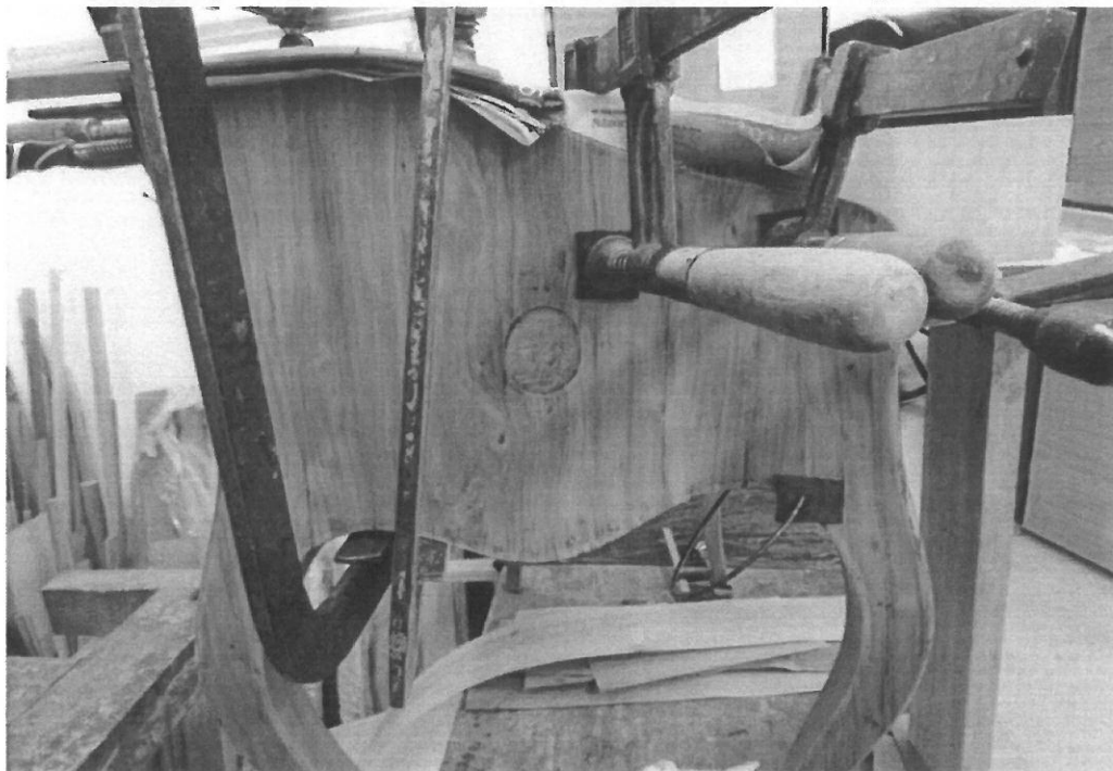
Na detailním snímku pohled na bok stolku po odstranění staré politury, příprava pro novou polituru.
