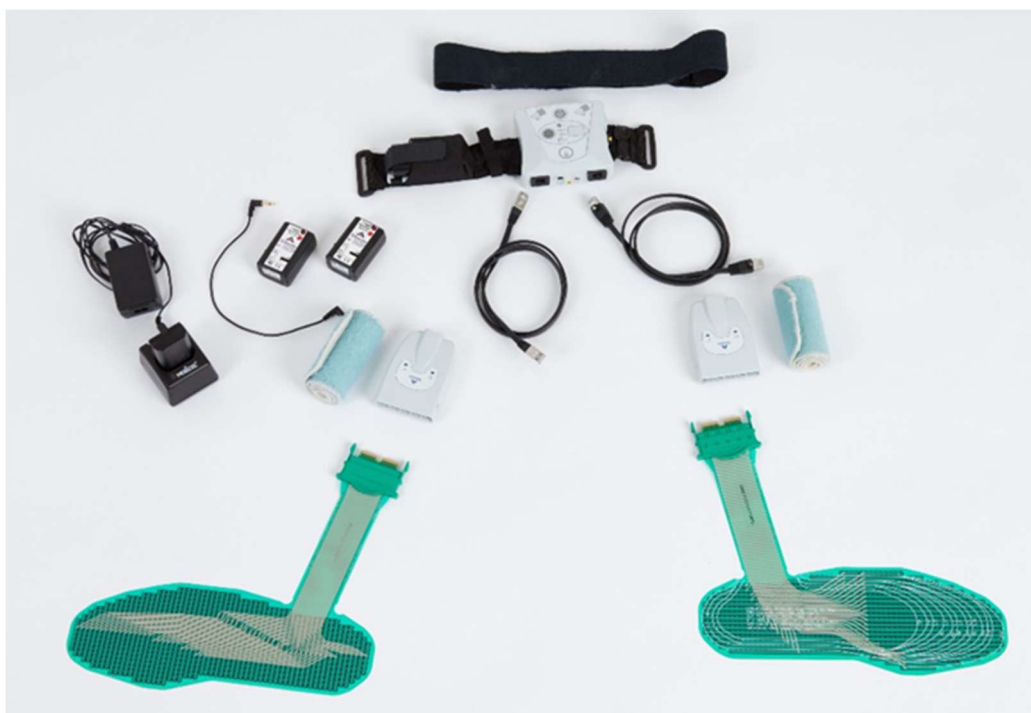
Obr. 1 – Skladba In shoe F-Scan systému
