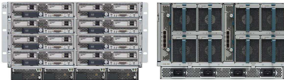
Obrázek 2. Přední a zadní strana skříně Cisco UCS 5108 Blade Server Chassis s blade servery
