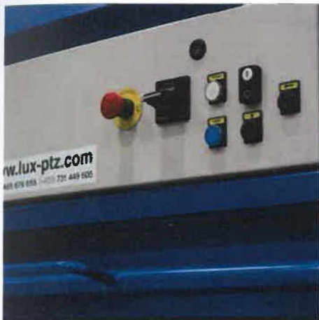
■ Jednoduché ovládání s elektrickým přejezdem lisovací hlavy
