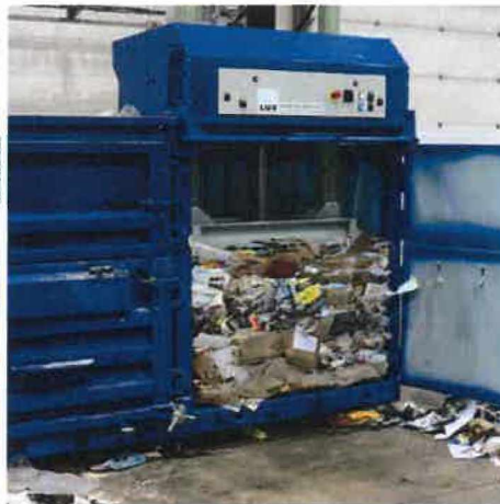
■ Automatické a bezpečné dveře - ruční vyklápění slisovaného balíku
