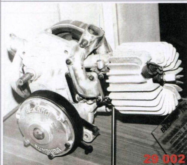
29002 Motocyklový motor Bekamo 174 ccm
