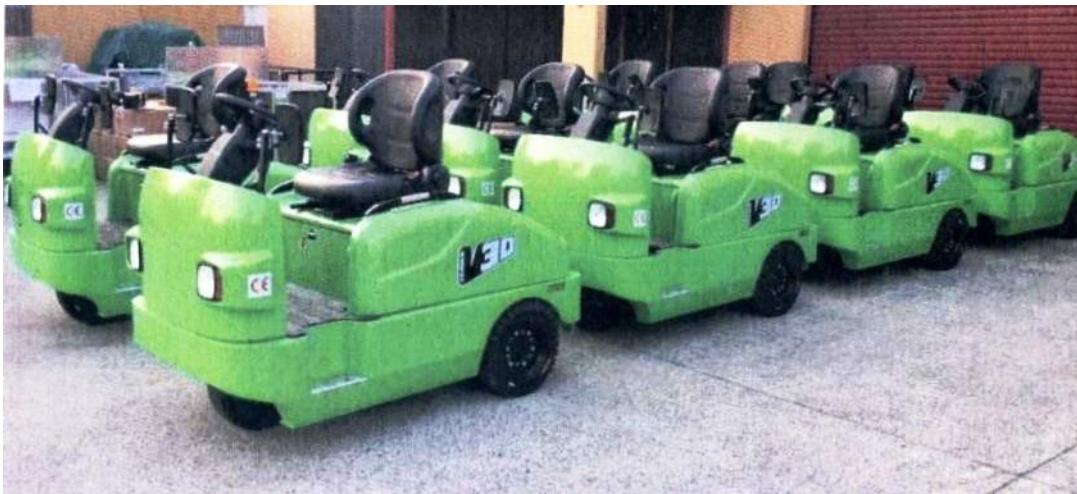
Akumulátorové tahače jsou určeny pro vnitropodnikové přesuny nákladů a materiálů. Další využití najdeme např. na letištích ve spojení s přepravními vozíky při převozu zavazadel. Vozíky jsou vybaveny silnou trakční baterií, která zajistí bezproblémový a ekologický provoz. K napájení jsou použity baterie o napětí 48 V. K regulaci pohonu se používá ověřená AC regulace. Standardně jsou vozíky vybaveny ochranným rámem obsluhy a dalšími bezpečnostními prvky včetně zábleskového majáku.
