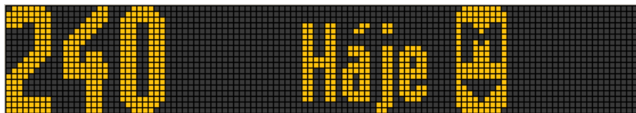
Obrázek 4: Nepřípustné zobrazení cílové zastávky na bočním tablu
