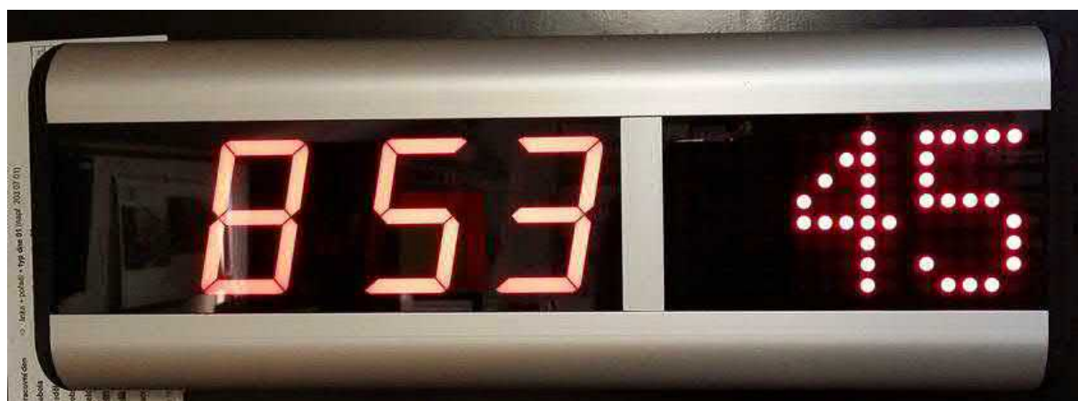
Obrázek 9: Zobrazovač času a pásma ZOC-3P/ETH
