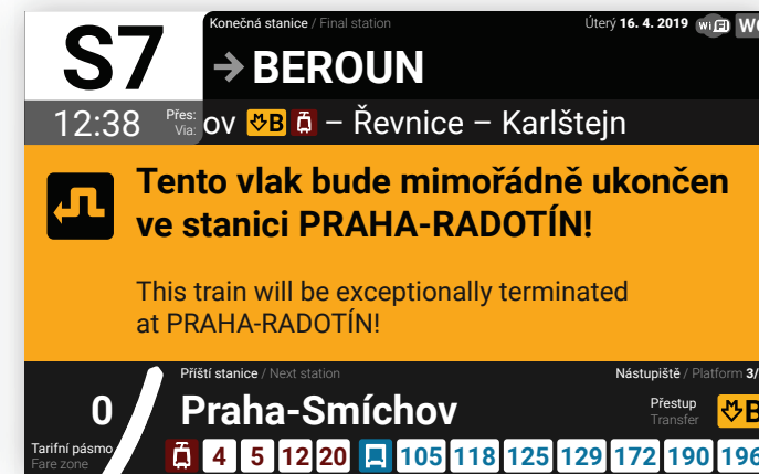
3. Sdělovací obrazovka (mimořádné ukončení) – obrazovka je zobrazena v momentě, kdy dojde ke změně konečné stanice (při zadání do systému).
