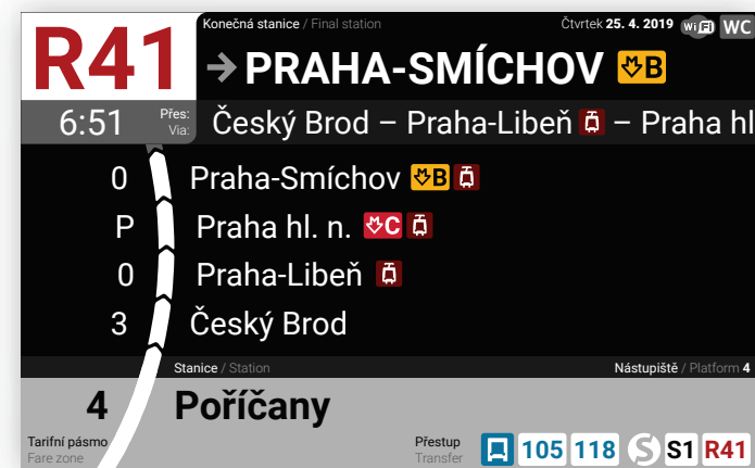
6. Základní obrazovka – vlak stojí ve stanici [Poříčany]. V záhlaví je již nové číslo linky a její konečná stanice.
