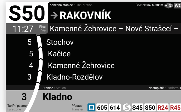
6. Přední část vlaku – Základní obrazovka – vlak stojí ve stanici (Kladno). Informace o zadní části vlaku se již nezobrazuje.
