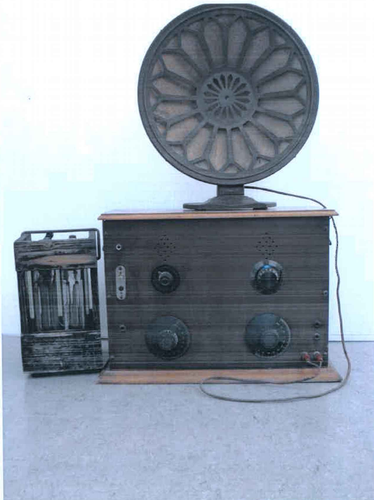
1. Telekra, čtyřlampový bateriový přijímač s odděleným diskovým elektromagnetickým reproduktorem Grawor
