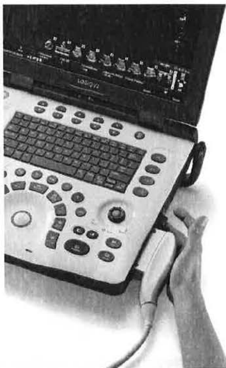
Obr. č. 3: Připojení sondy k LOGIQ V2
