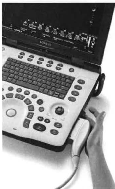
Obr. č. 3: Připojení sondy k LOGIQ V2
