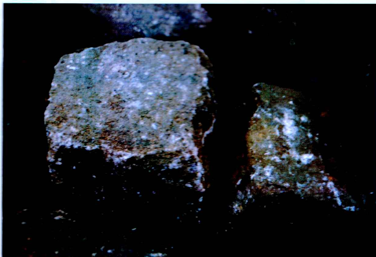
Obr. č. 6 Rozměrová a tvarová různorodost, podkosení.
