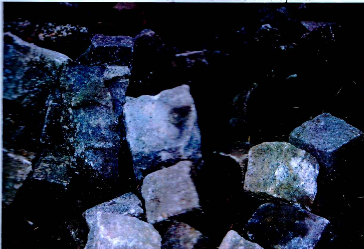
Obr. č. 5 Rozměrová a tvarová různorodost, podkosení, oláman, asfaltové příměsi
