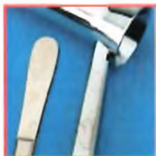
Skvrny způsobené vysokým obsahem soli v proplachovací vodě
