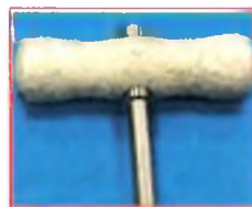
Plošná koroze materiálu - pouze hliníkové rukojeti Příčina: použití silného alkalického čisticího prostředku
