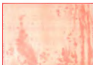
Optické změny u barevně eloxovaného hliníku se objevují i při použití slabých alkalických roztoků
