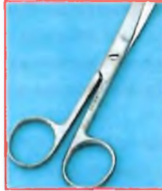
Nůžky s důlkovou korozi
