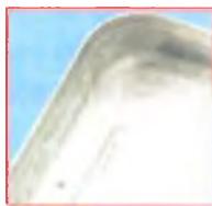
Plošná koroze vany kontejneru Příčina: ošetření alkalickým čisticím prostředkem
