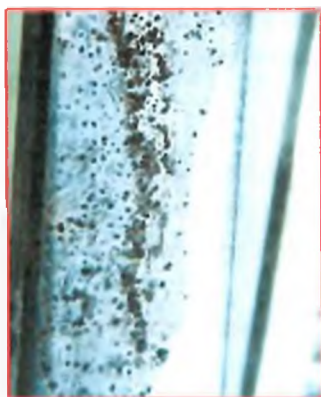
Usazeniny leptavého prostředí obsahujícího chloridy na nástroji
