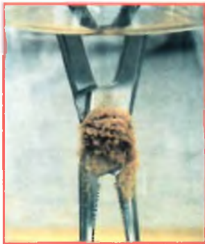
Vytvoření rzi při vícehodnovém ponoření do fyziologického roztoku
