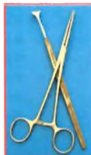
Koroze při styku nerez oceli s mosazí
