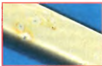
Chloridem způsobená důlková koroze na nástroji
