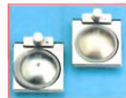
Netěsnící ventil trokaru při zpuchření jako následek kontaktu s olejem
