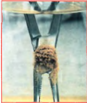
Vytvoření rzi při vícehodnovém ponoření do fyziologického roztoku
