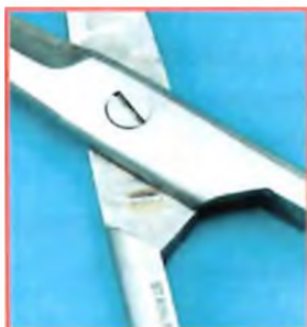
Koroze z oděru, způsobená neodpovídajícím promazáním olejem
