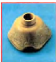
Trhlinka a poškození povrchu vysokou teplotou při sušení
