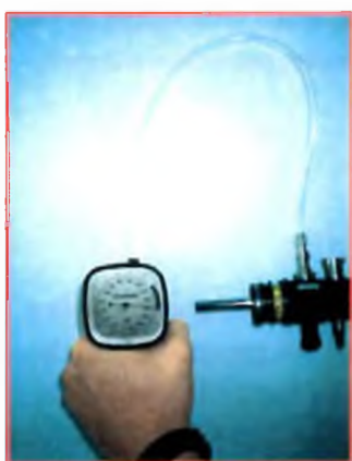
Ruční zkouška těsnosti ohebného endoskopu
