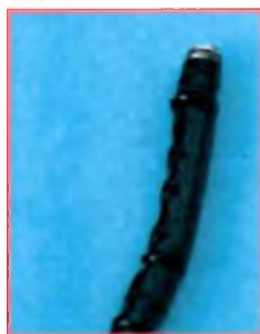
Nabobtnání na distálním konci fibroskopu
