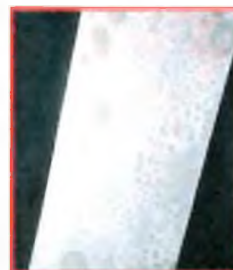
Povrch nástroje se skvrnami ve tvaru kapek
