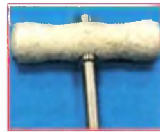
Plošná koroze materiálu - pouze hliníkové rukojeti Příčina: použití silného alkalického čistícího prostředku
