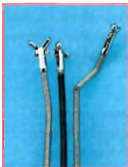
Násilně poškozené bioptické kleště
