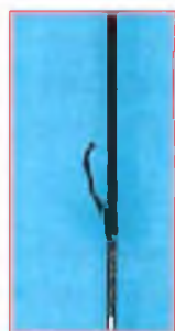
Poškozená izolace na VF nástroji
