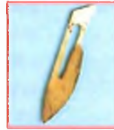
Rez na čepelce skalpelu. Příčina: materiál, nejedná se o nerezovou ocel, výrobek pro jednorázové použití
