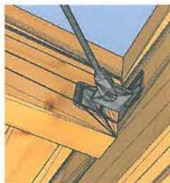
Z/09 Kotvení táhla ve střeše, 1,21 kg
