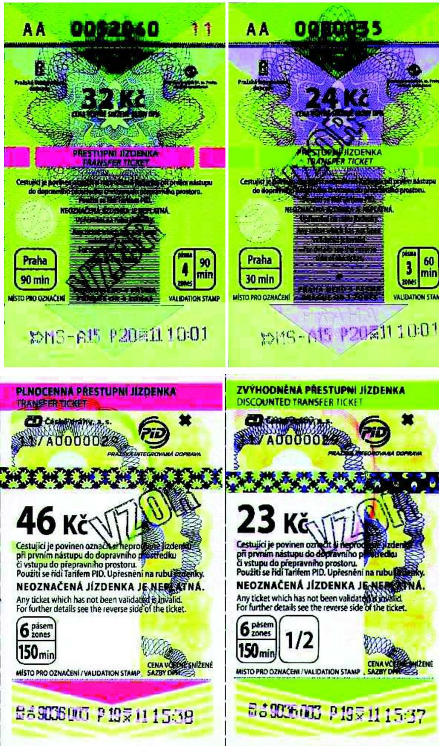
Označovací pole je tvořeno chemicky reagujícími proužky, které způsobí dvoubarevné zabarvení vytištěných údajů po označení. Změna barvy je patrná již 30 sekund až 1 minutu po označení, k úplnému vybarvení dochází přibližně za 5 minut. Údaje z označovače na jízdenkách jsou shodné s údaji uvedenými u jízdenek ze stacionárního automatu. Tyto informace se vztahují ke všem jízdenkám vydávaným v předprodeji.
