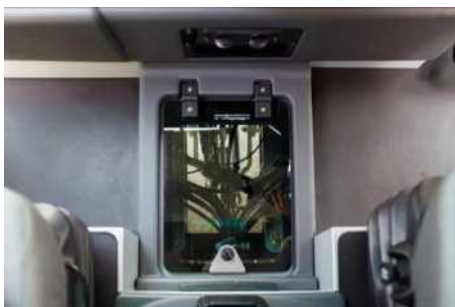
Kontrolní okénko v podlaze kabiny umožňuje výhled na hubici.
