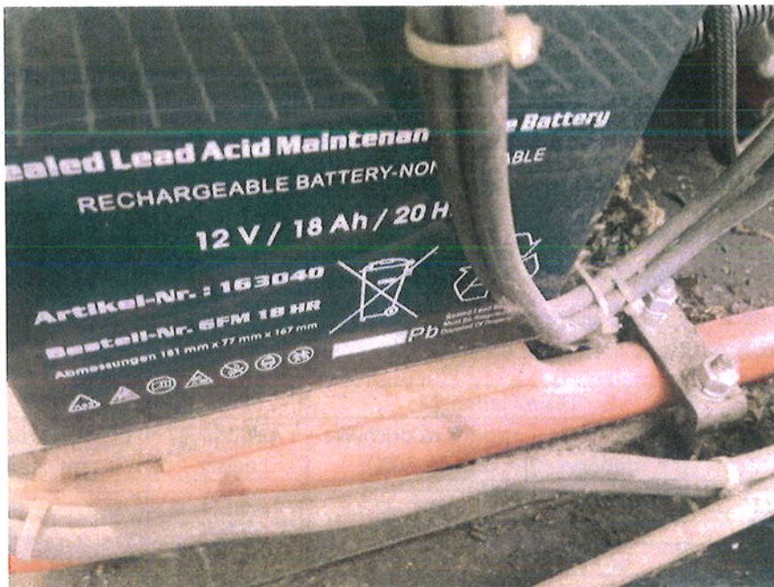
Obr. 1 Bezúdržbový startovací akumulátor s vyznačenou kapacitou
