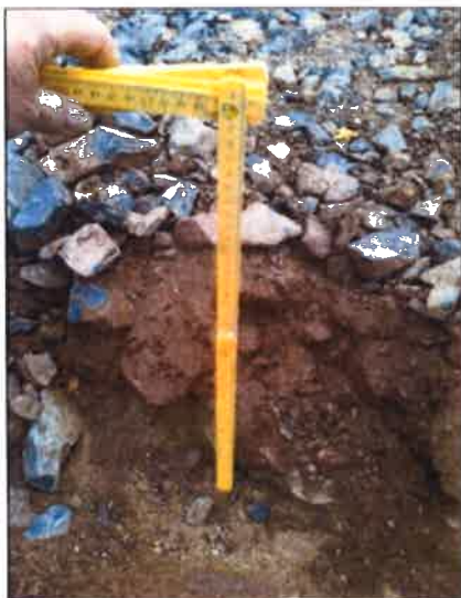
1 - profil konstrukčními vrstvami
