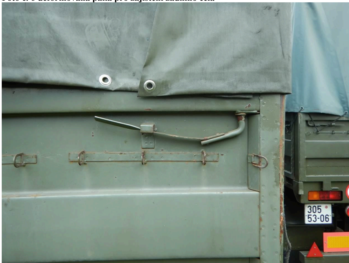
Foto č. 6 deformovaná páka pro zajištění zadního čela
