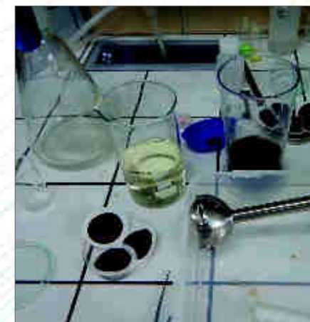
Obr. 21a. Příprava umělých analogů detritu v laboratoři. Zcela vlevo filtrační zařízení, v kádince přirozená voda na ředění, dole GF/C filtry s pevnou frakcí po filtraci homogenizátu, mixérová nádoba a nerezový tyčový mixér.
