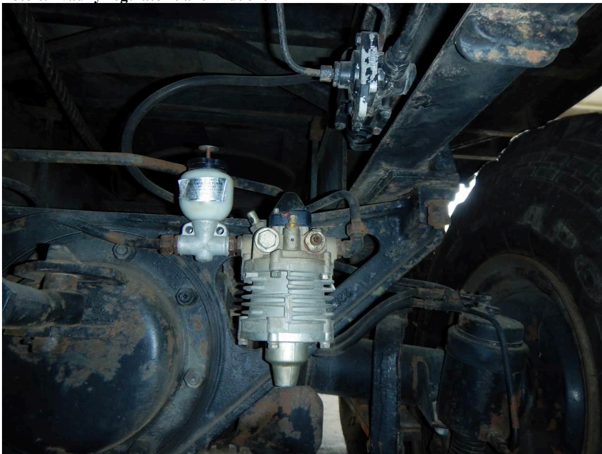
Foto č.7 vadný regulátor tlaku vzduchu
