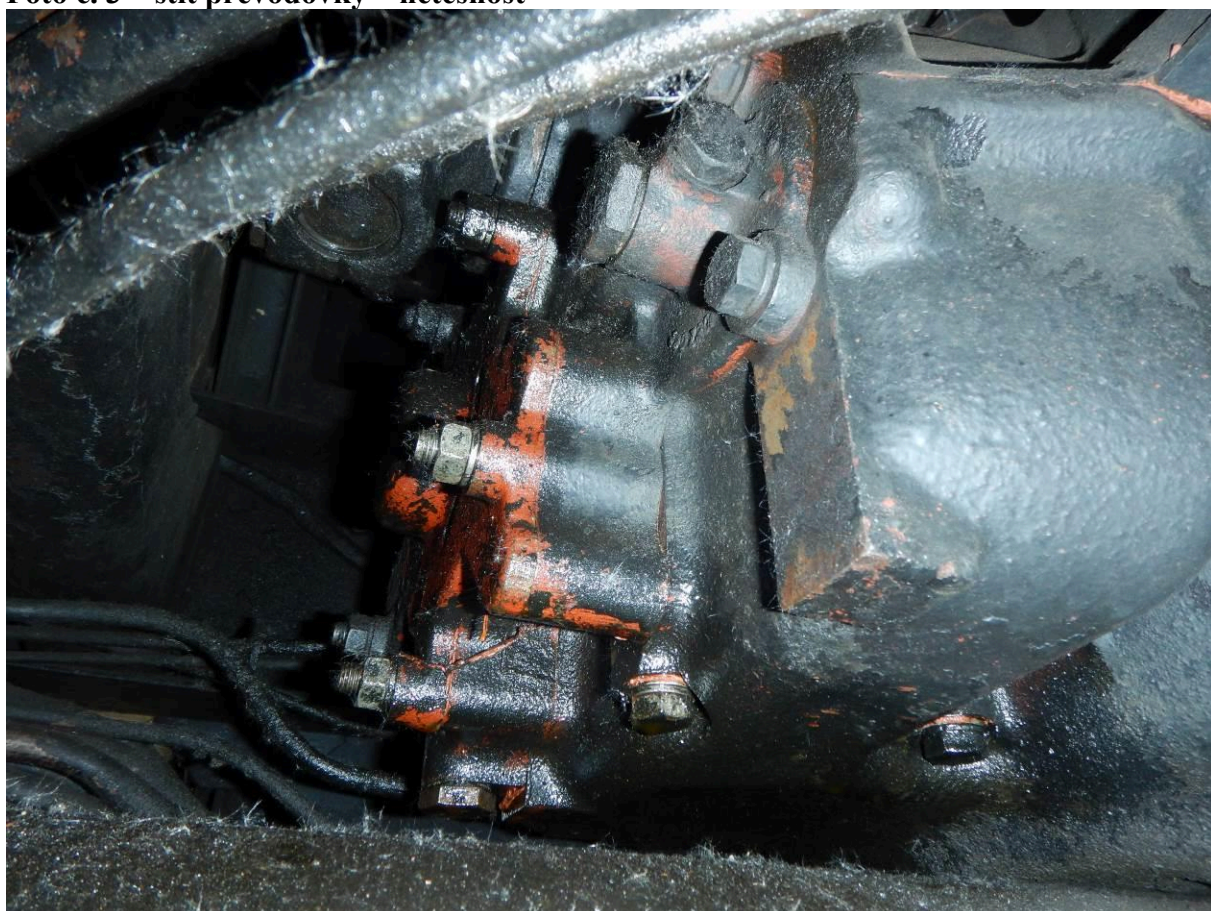
Foto č. 3 – štit převodovky – netěsnost
