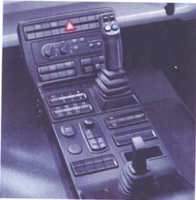
Středový ovládací panel s joy-stickem pro ovládání hydrauliky, spínači funkcí, ovládací tlačítka s podsvětlením, nastavení topení a klimatizace, páka ruční brzdy. Předvolič pro řazení převodovky vpravo pod volantem
