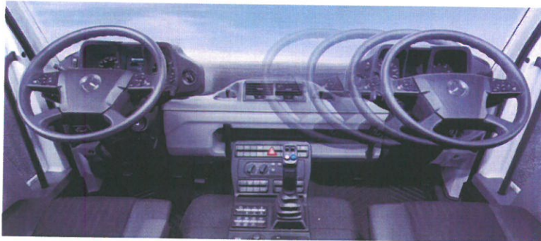
Systém posuvného řízení VarioPilot , který umožňuje posouvat volant a pedálovou skupinu z levé na pravou stranu a zpět pro práci vpravo a vlevo
