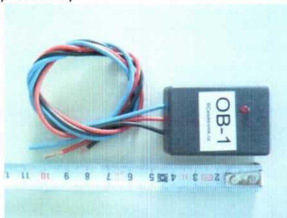
Obrázek 4: Multifunkční odpojovač spotřebičů – rozměr
