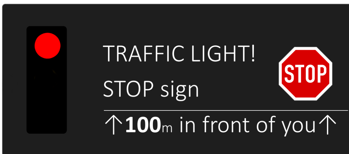
Obrázek 50: Možnost prezentace zprávy v rámci služby ISV (stav SSZ) na displeji ve vozidle
