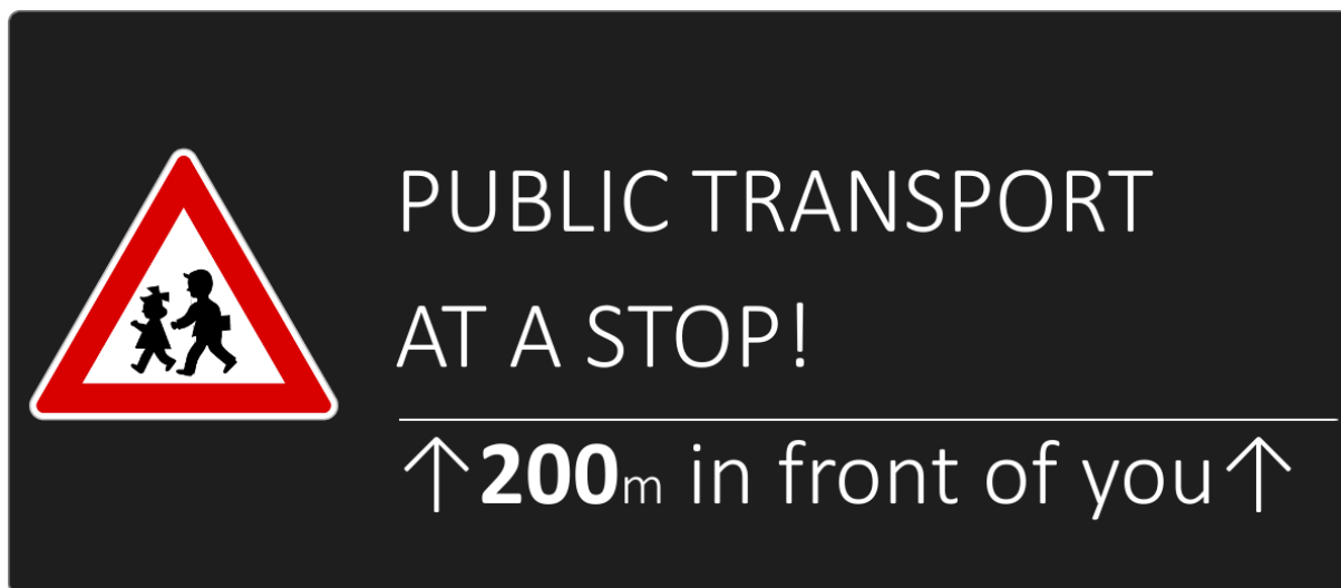
Obrázek 59: Možnost prezentace zprávy v rámci služby PTS (vozidlo v zastávce) na displeji ve vozidle
