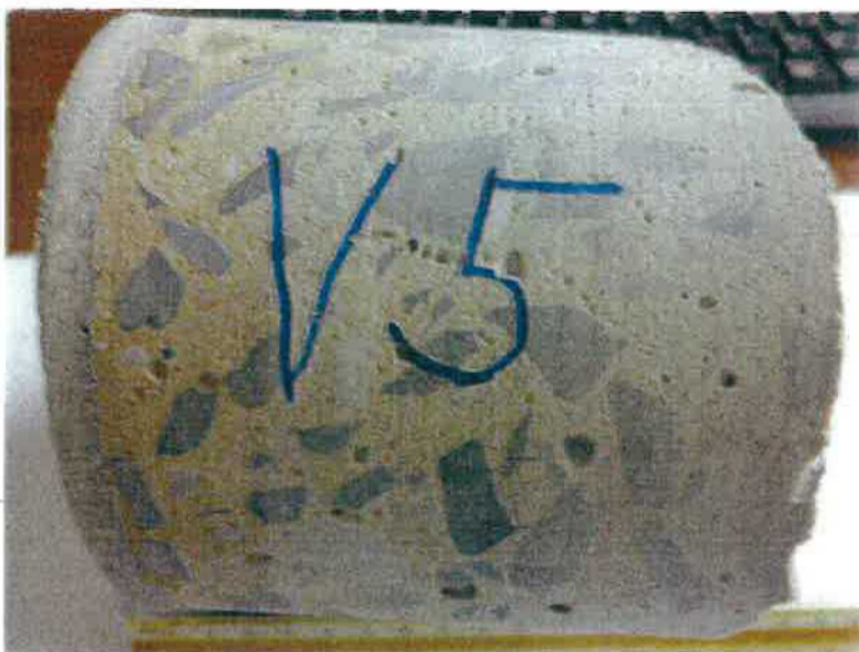
Obr. 2.5 – vývrt V5 z levé opěrné zdi za O10
