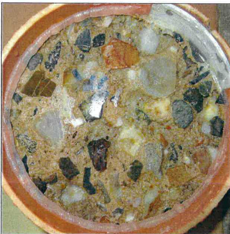
Foto 6: Pohled na líc vzorku V2 – po CH.R.L. - metoda C – 75 cyklů
