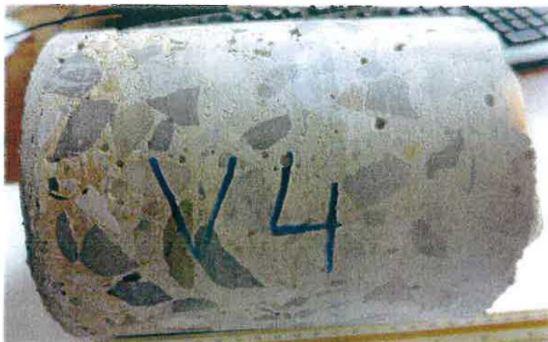
Obr. 2.4 – vývrt V4 z pravé opěrné zdi před O1
