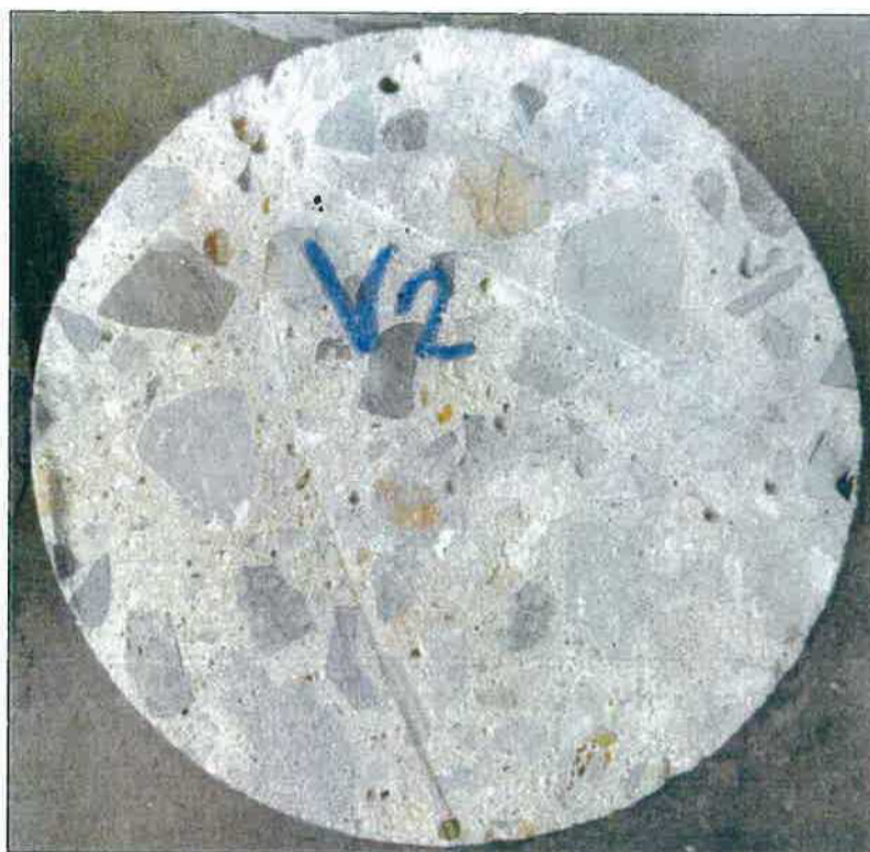
Foto 5: Pohled na líc vývrtu V2 před zkouškou
