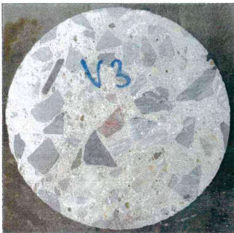
Foto 7: Pohled na líc vývrtu V3 před zkouškou
