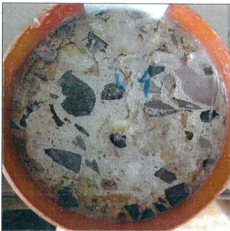
Foto 4: Pohled na líc vzorku V1 – po CH.R.L. - metoda C – 75 cyklů
