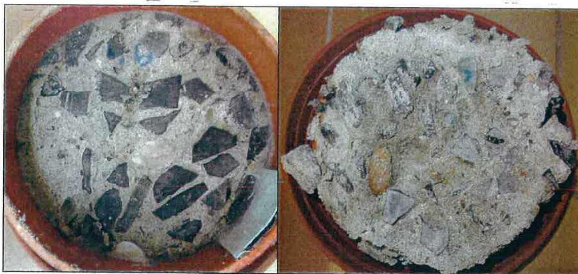
Foto 14: Pohled na líc a „dno“ vzorku V6 – po CH.R.L. - metoda C – 75 cyklů
