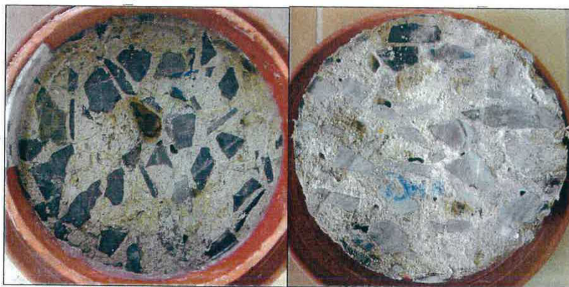
Foto 12: Pohled na líc a „dno“ vzorku V5 – po CH.R.L. - metoda C – 75 cyklů
