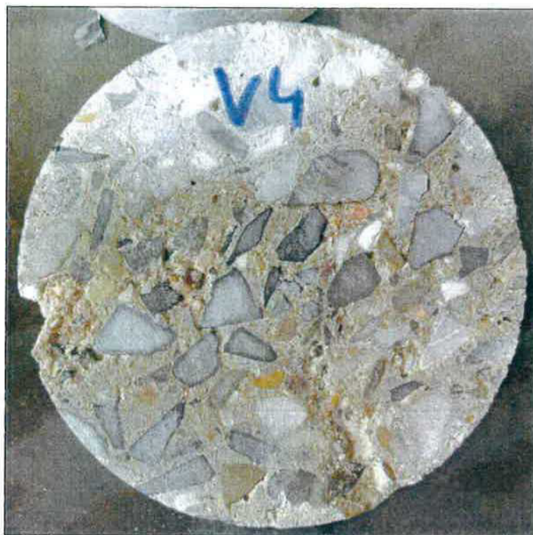
Foto 9: Pohled na líc vývrtu V4 před zkouškou
