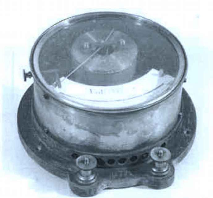
Rozvaděčový voltmetr 0-300 V, syst. Hummel
