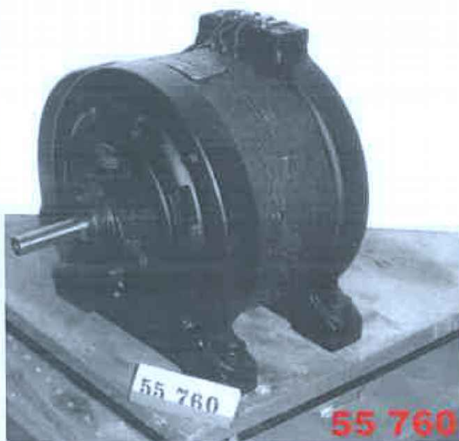
Motor asynchronní s kotvou nakrátko
