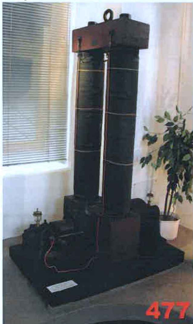
Dynamo Edisonova typu, výkon 4 kW
