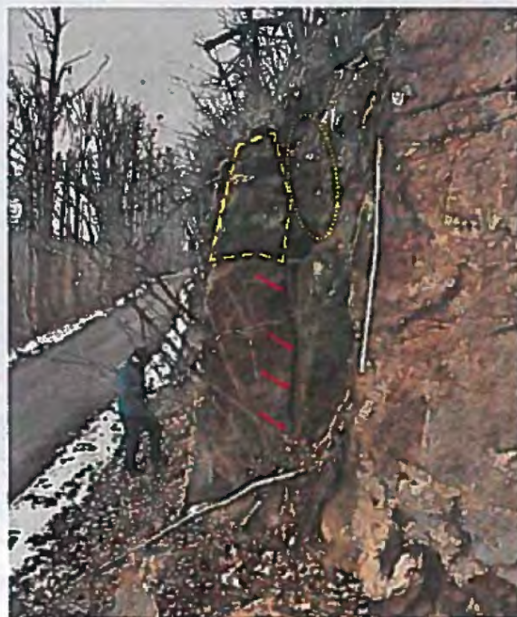
Foto 6: Skalní objekt (z foto 5) ze strany. Objekt je v mírném záklonu a oddělený od skalního masivu podél pukliny, na kterou ukazují červené šipky. Žlutý polygon vyznačuje část, kterou je možné odtěžit. Žlutá tečkovaná elipsa vyznačuje zasucenou rozevřenou puklinu. Po odtěžení svrchní partie je pak nutné puklinu zaplombovat.
