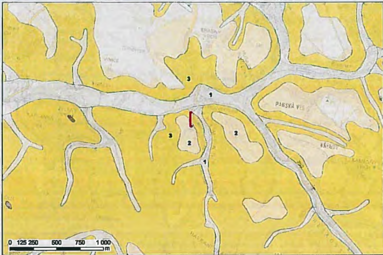
Obr. 1. Zjednodušená geologická situace širšího okolí řešeného silničního zářezu (průběh viz červená čára ): 1 – fluviální a splachové hlíny a písky (kvartér); 2 – naváté (eolické) spraše a sprašové hlíny (kvartér); 3 – křemenné pískovce kvádrové (křída); (zdroj: www.geology.cz ).
